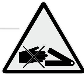
**Tenga cuidado cuando ajuste o pliegue los apoyos contra volqueo, especialmente durante el ajuste y el accionamiento con la mano. Debido a la alta fuerza elástica existe peligro de aplastamiento entre la barra de retención [A] y el bloque de tope [B].**
