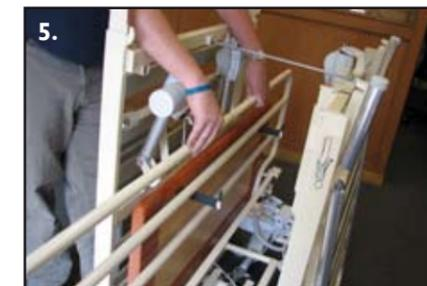
5. Barrières et Panneaux de lit sont positionnés sur les barres de renfort. La potence est installée sur la base côté panneaux.
