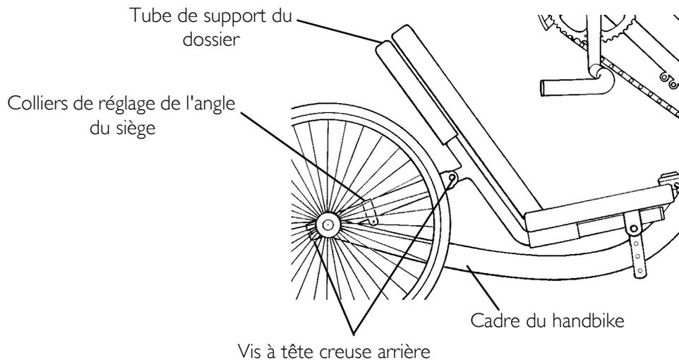
**FIGURE 6.9** Réglage de l'inclinaison du dossier - Tous les modèles excepté Top End XLT Gold et Top End Force
