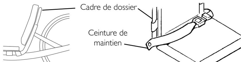
**FIGURE 9.7** Installer la ceinture de maintien
