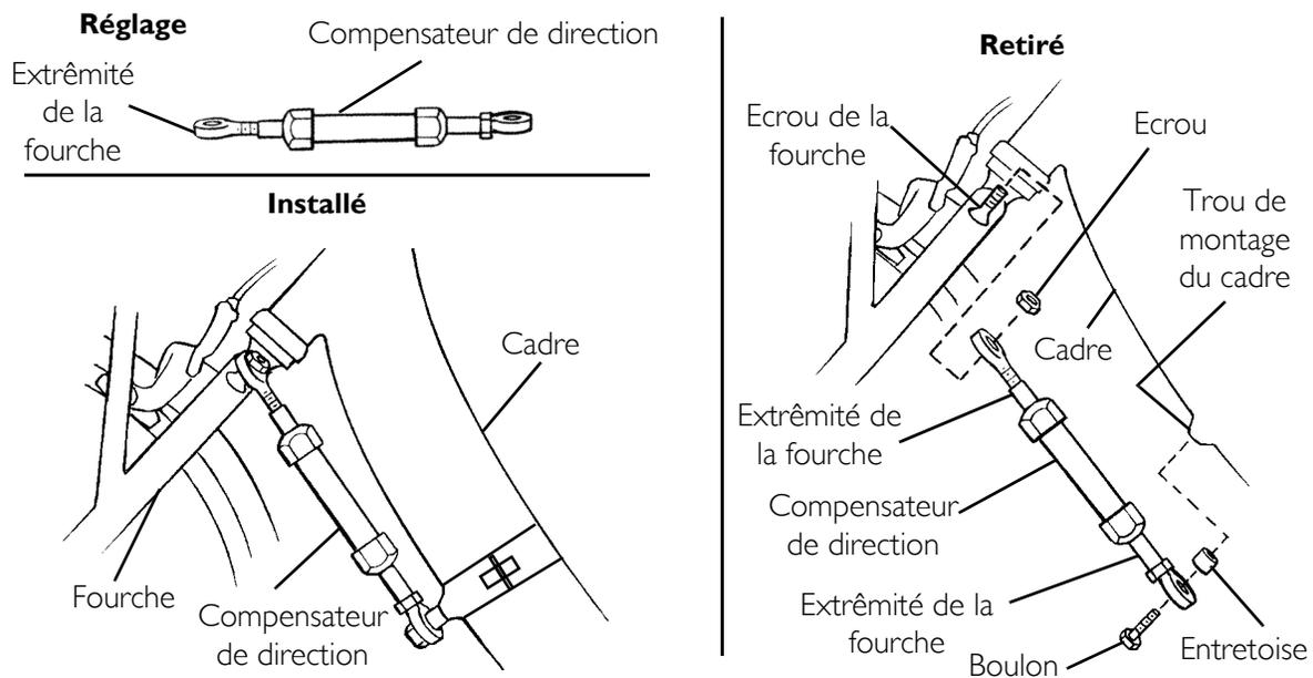
**FIGURE 8.3** Installer/Enlever/Régler le compensateur de direction
