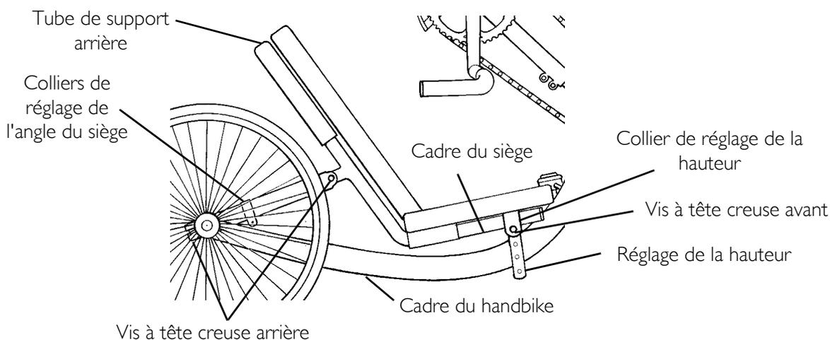
**FIGURE 6.6** Régler le siège en avant/arrière - Tous les modèles sauf Top End XLT Gold et Top End Force
