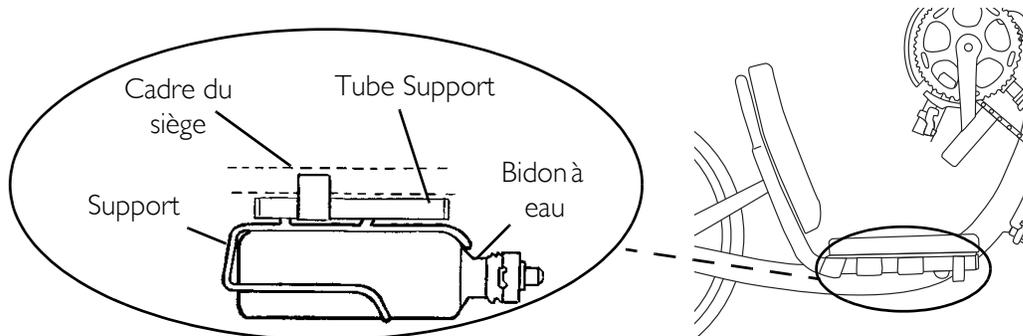
**FIGURE 9.2** Installer le bidon à eau
