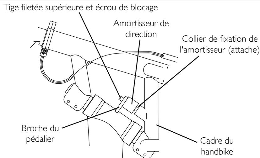
**FIGURE 8.4** Installer/enlever /régler l'amortisseur de direction - Pour le Top End XLT Gold et Force Uniquement
