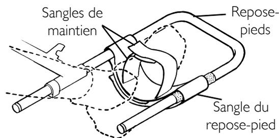
**FIGURE 6.2** Utiliser les sangles des repose-pieds
