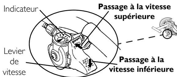
**FIGURE 5.2** Changement de vitesses - Plateau à 7 vitesses
