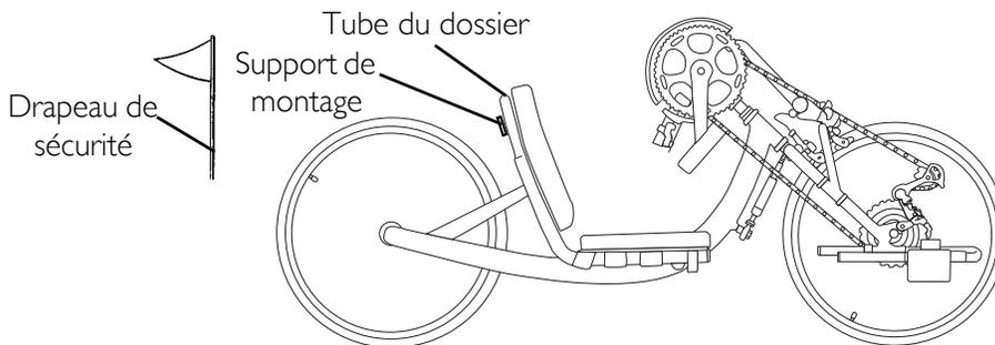
**FIGURE 9.5** Installer le drapeau de sécurité
