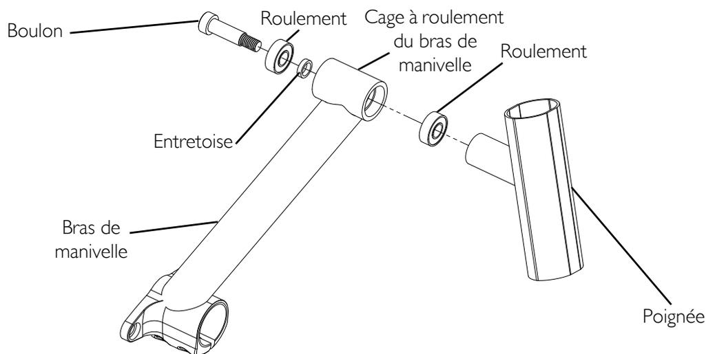
**FIGURE 9.10** Installer les poignées V/S - Pour les modèles fabriqués avant le 07/12/2007
