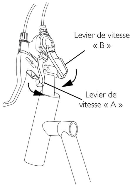
**FIGURE 5.3** Changement de vitesses - Système de changement de vitesse/freinage rapide: 27 vitesses - Système de changement de vitesse/freinage rapide: 27 vitesses
