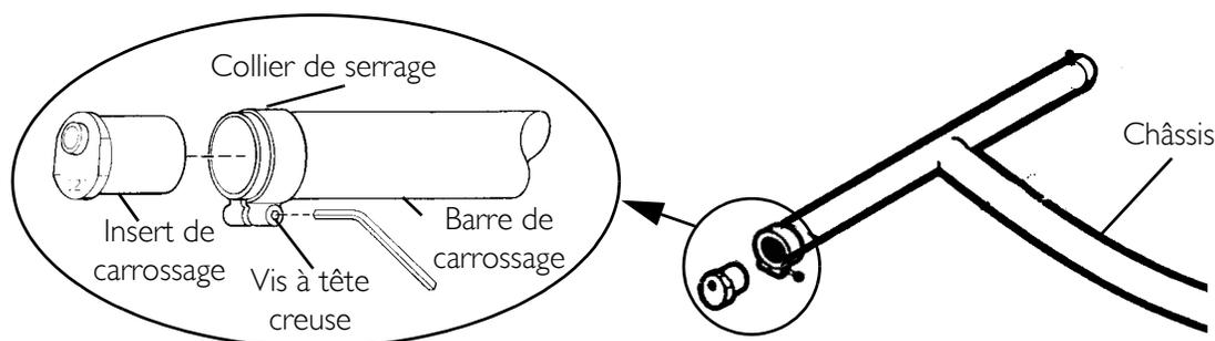
**FIGURE 7.4** Remplacer les inserts de carrossage
