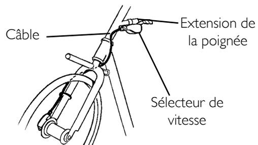
**FIGURE 8.5** Installer le câble de l'embrayeur à 7 vitesses
