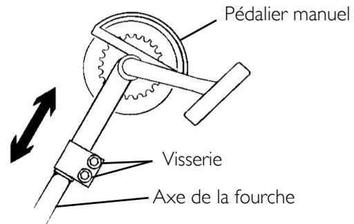
**FIGURE 6.4** Régler la hauteur du pédalier - Tous les modèles sauf Top End XLT Gold
