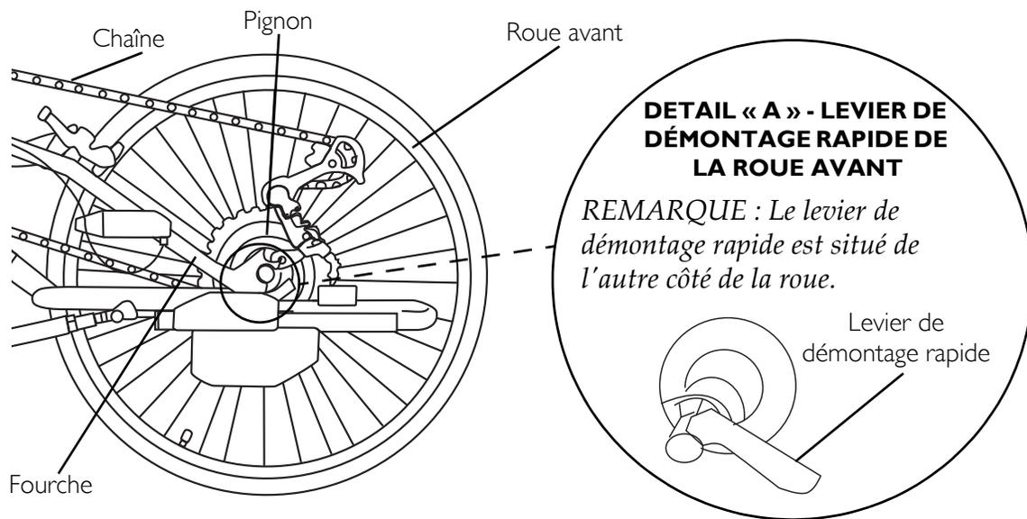
**FIGURE 9.17** Enlever/Installer la roue avant - XLT Gold, XLT Pro et XLT avec dérailleur de vitesse
