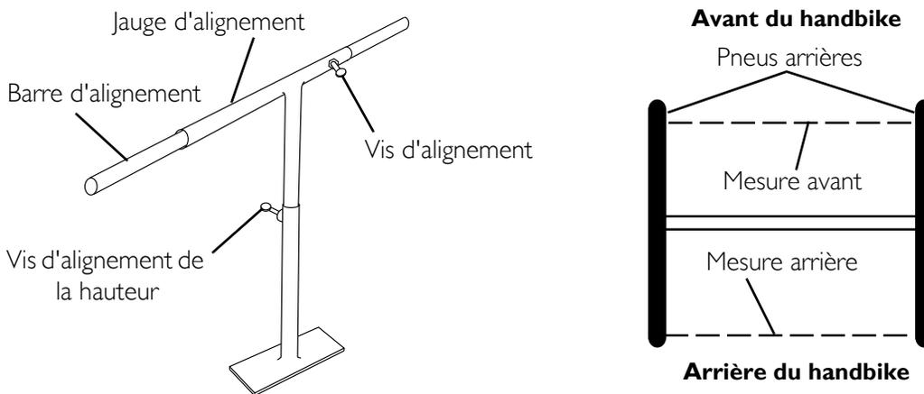
**FIGURE 9.19** Utiliser la jauge d'alignement
