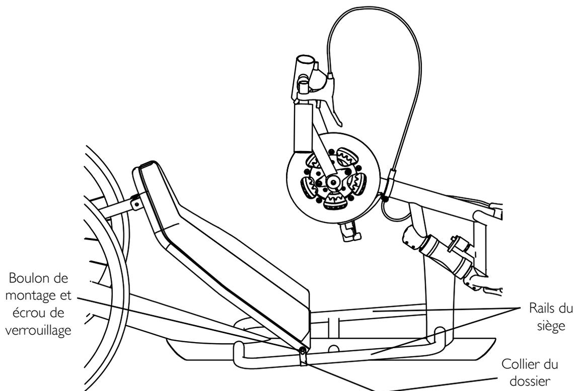
**FIGURE 6.7** Avancer/reculer le siège - Top End XLT Gold et Top End Force uniquement
