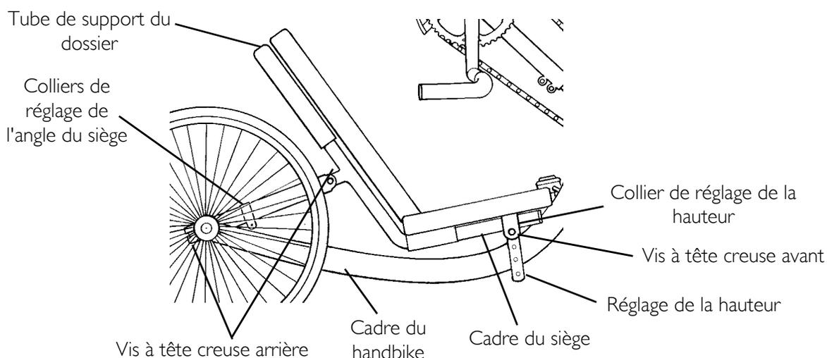
**FIGURE 6.8** Régler la hauteur d'assise - Tous les modèles sauf Top End XLT Gold et Top End Force
