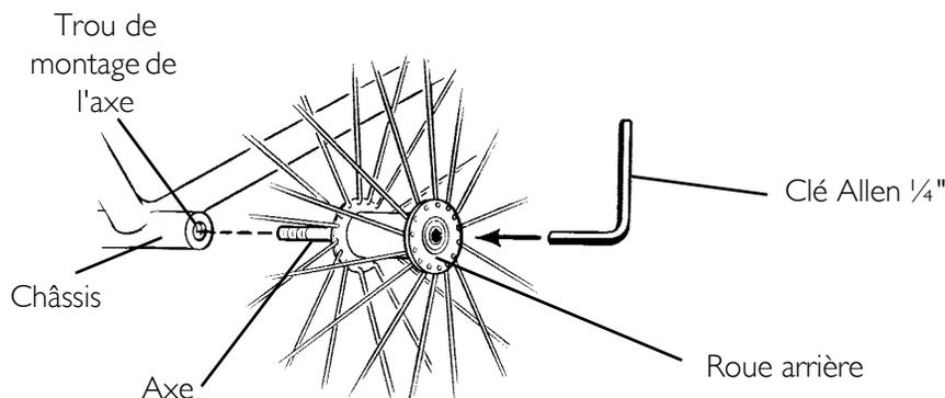
**FIGURE 7.2** Installer les roues arrières avec les axes filetés
