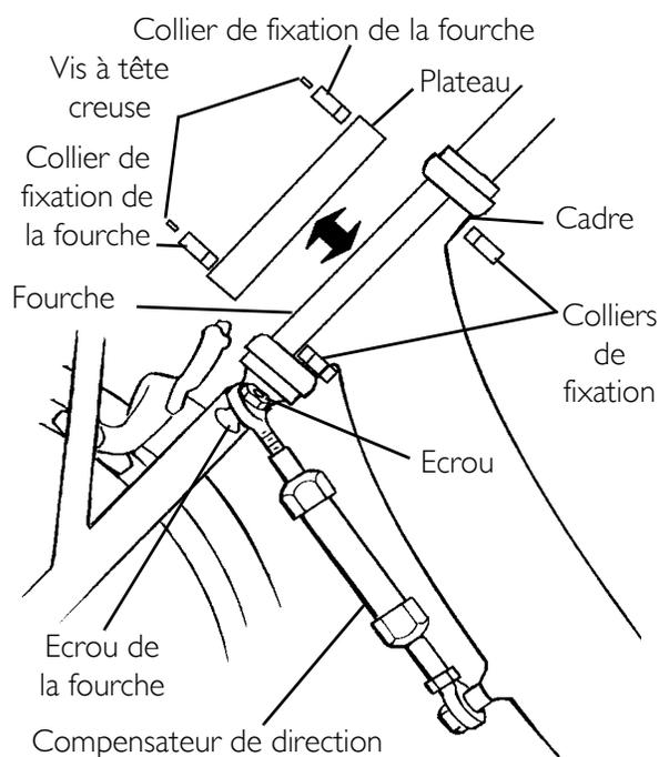
**FIGURE 9.15** Enlever/Installer la fourche amovible pour le transport XLT PRO équipé d'un compensateur de direction
