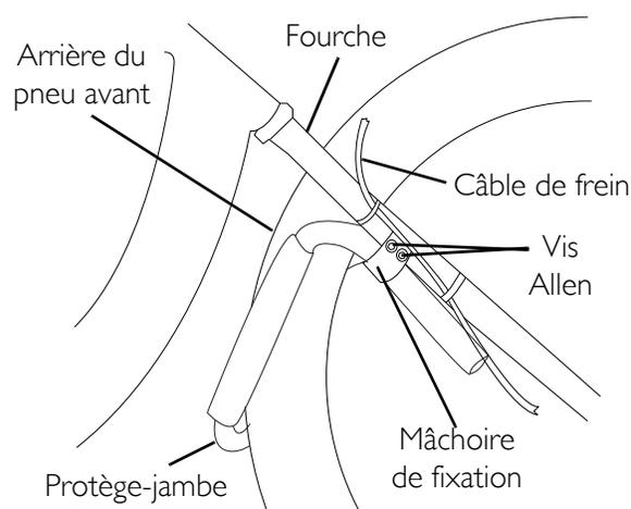
**FIGURE 6.1** Remplacer/Régler le repose-pieds et le protège-jambe
