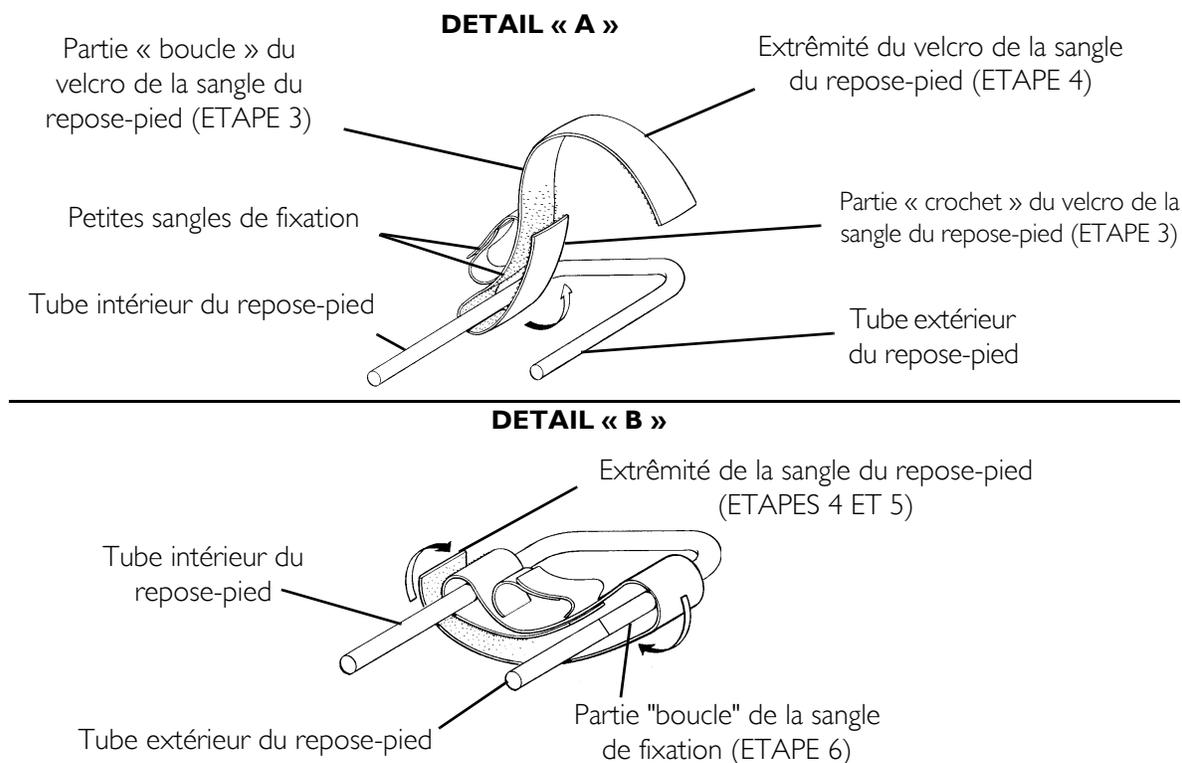
**FIGURE 6.3** Utiliser les sangles des repose-pieds Remplacer la sangle du repose-pied
