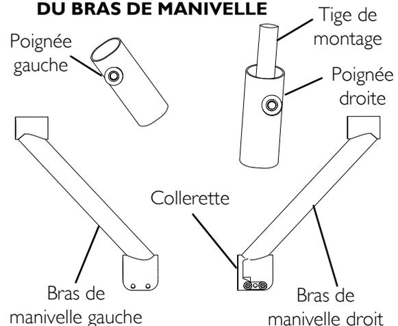
**FIGURE 9.11** Installer les poignées V/S - Pour les modèles fabriqués avant le 07/12/2007
