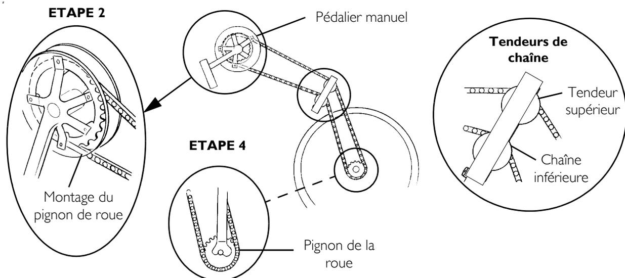
**FIGURE 8.6** Installation du plateau de chaîne à 7 vitesses
