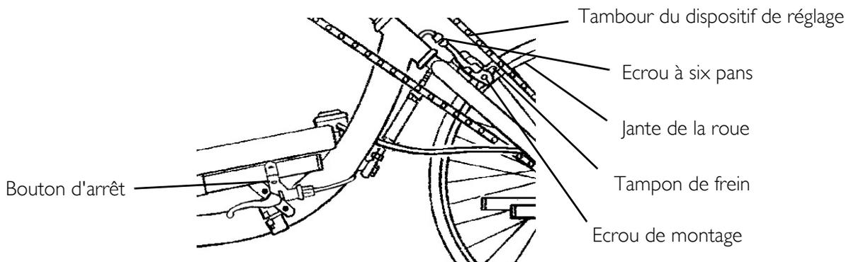
FIGURE 8.10 Régler/remplacer le frein de parking
