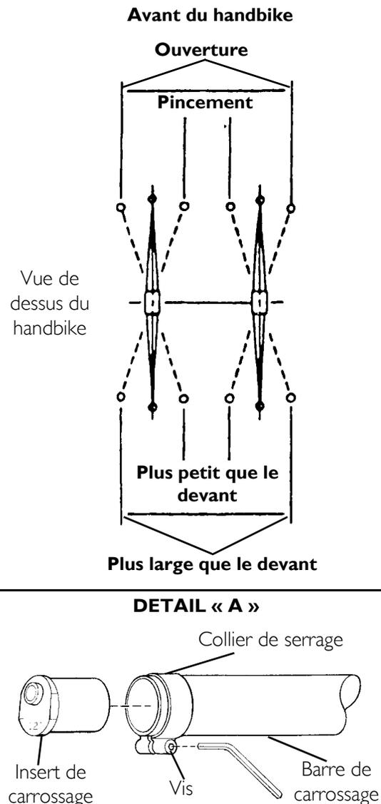
**FIGURE 7.3** Déterminer/Régler le pincement/l'ouverture
