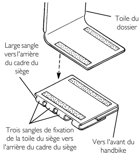
**FIGURE 8.11** Remplacer la toile du siège
