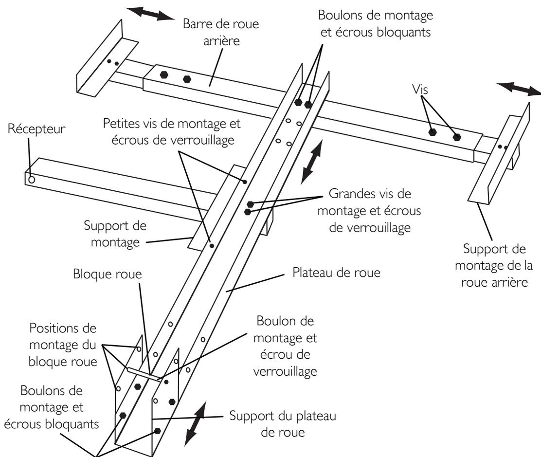
**FIGURE 9.18** Assembler/Utiliser/Régler l'attelage de remorquage du handbike
