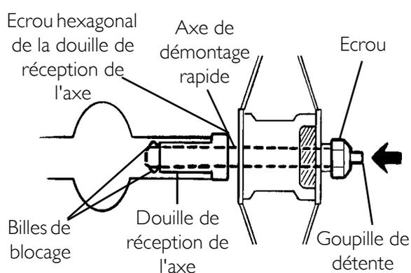
FIGURE 7.1 Installer/Régler la roue arrière et les axes à démontage rapide
