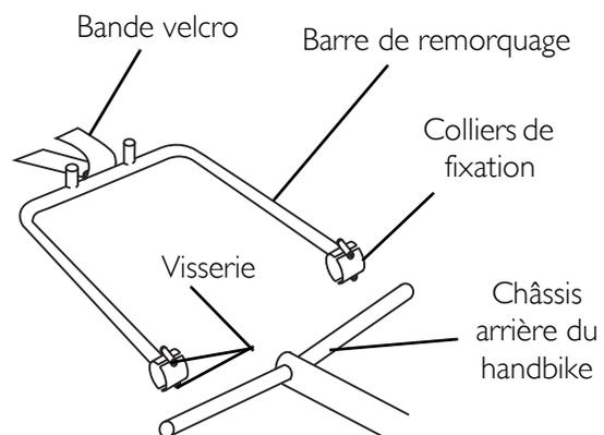
**FIGURE 9.3** Installer/utiliser la barre de remorquage
