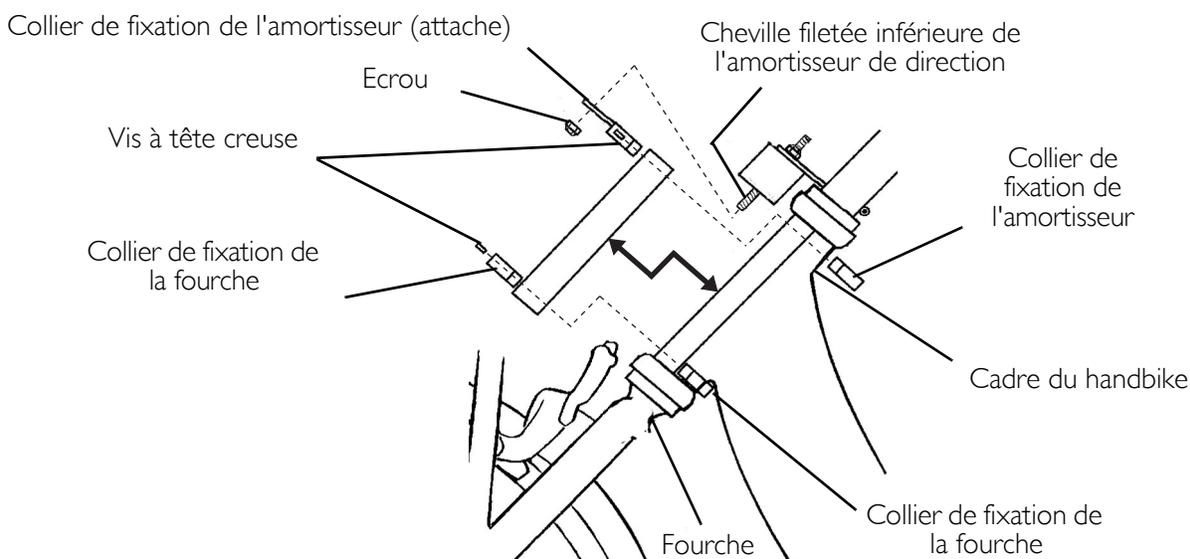
**FIGURE 9.16** Enlever/Installer la Fourche - XLT Gold, et Top End Force équipés d'un amortisseur de direction
