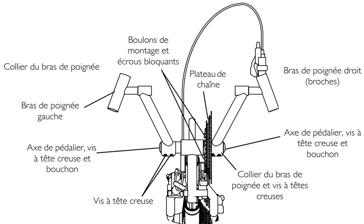
**FIGURE 8.2** Remplacer les poignées du pédalier - Top End XLT Gold, XLT PRO et Top End Force
