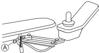
1. Lösen Sie die Schrauben (A).
