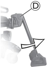
Lösen Sie die Schraube **D** und schwenken Sie die Beinstütze nach oben, um an den Gummianschlag zu gelangen.
