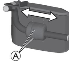
1. Lösen Sie die Inbusschrauben (A).
