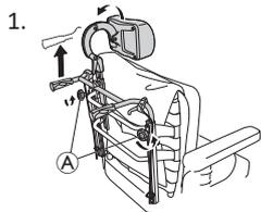
1. Lockern Sie die Handräder **A** und ziehen Sie die Schiebegriffe so weit wie möglich nach oben.
