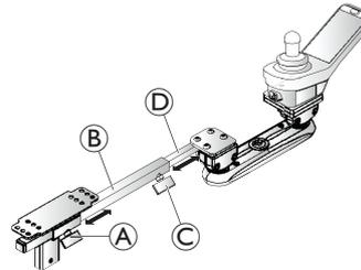
1. Lösen Sie die Flügelschraube (A), um die Tiefe des Rohrs (B) einzustellen. Ziehen Sie die Schrauben bei Erreichen der gewünschten Position fest. und / oder
