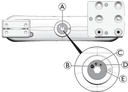
1. Stellen Sie die Abreißspannung mit dem Nockenrad **A** auf eine der vier Einstellmöglichkeiten ein:
