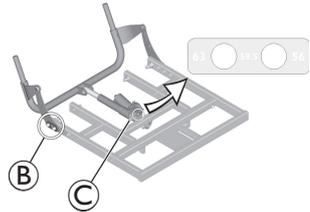
Entfernen Sie auf beiden Seiten die Schrauben, Unterlegscheiben und Abdeckplatten **B**.
