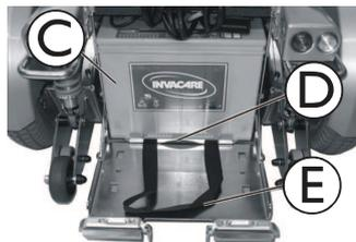
Ziehen Sie die Batterien **C** und die Batteriehalterung **D** am Riemen **E** bis zum Anschlag nach vorn.
