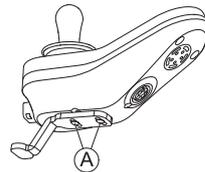
1. Lösen Sie die Schrauben (A).
