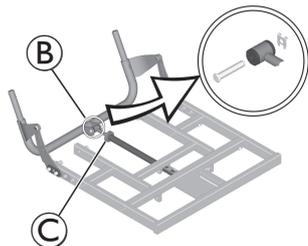
Entfernen Sie den Einsatz und den Bolzen **B**.
