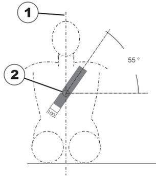
Der im Transportfahrzeug installierte Sicherheitsgurt sollte wie in der Abbildung oben gezeigt angelegt werden.
