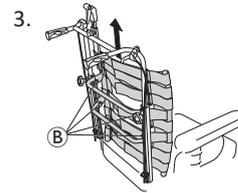
3. Lösen Sie die Schrauben **B** und entfernen Sie die Rückenlehne, indem Sie sie nach oben herausziehen.
