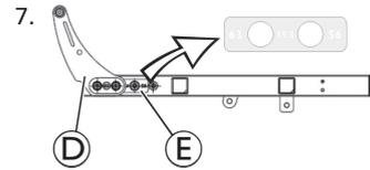
Passen Sie die Tiefe der Auflageplatten **D** wie gewünscht an. Orientieren Sie sich dabei an der Kennzeichnung am Sitz **E**.
