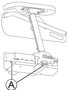
1. Lösen Sie die Schrauben **A**.
