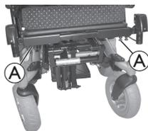
1. Lösen Sie die Schrauben (A).
