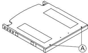
Lösen Sie die Schrauben **A** und entfernen Sie die Sitzplatte.
