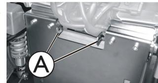
Drücken Sie die beiden Verriegelungsbolzen (A) nach innen und öffnen Sie die Batterieabdeckung.
