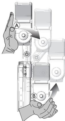
1. Drücken Sie die Mitte des Fahrpults (A) zur Bedienung des Schwenkmechanismus.
