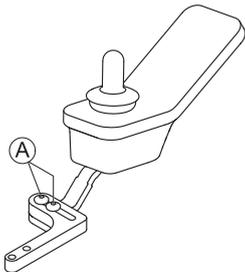
1. Lösen Sie die Schrauben (A).
