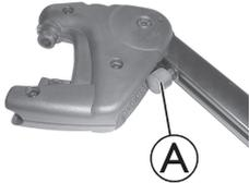
Die Endposition der Beinstütze wird durch einen Gummianschlag **A** bestimmt.
