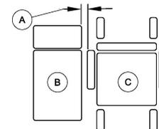
1. Reduzieren Sie den Spalt zwischen der Transferfläche (B) und dem Sitz des Elektrorollstuhls (C) auf den für das Durchführen des Transfers erforderlichen minimalen Abstand (A). Dies muss gegebenenfalls durch eine Begleitperson erfolgen.
