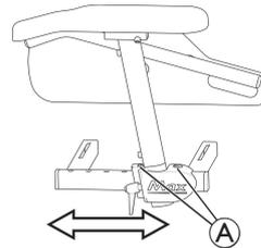
1. Lösen Sie die Schrauben **A** und entfernen Sie sie.
