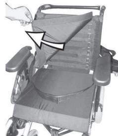
Entfernen Sie das Rückenpolster (mit Klettband befestigt), indem Sie es nach oben abziehen, um die Verstellbänder zugänglich zu machen.
