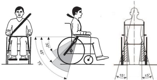
Der Beckengurt sollte zwischen Becken und Oberschenkel des Benutzers verlaufen und darf weder blockiert werden noch zu locker sitzen. Der ideale Winkel des Beckengurts zur Horizontalen liegt zwischen  $45^\circ$  und  $75^\circ$ . Der größte zulässige Winkel beträgt zwischen  $30^\circ$  und  $75^\circ$ . Der Winkel sollte niemals kleiner als  $30^\circ$  sein!
