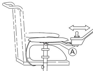
1. Lösen Sie Flügelschraube **A**.
