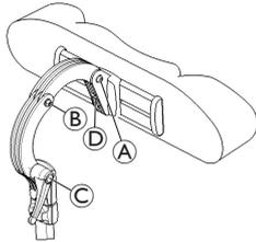
1. Lösen Sie die Schrauben **A** oder **B** oder den Klemmhebel **C**.
