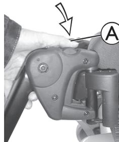
1. Drücken Sie die Entriegelungstaste (A), um die Beinstütze in der oberen Position zu entfernen.
