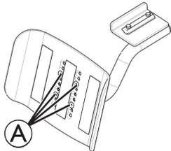
Entfernen Sie die Schrauben (A).
