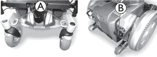
Sichern Sie den vorwärtsgerichteten Elektrorollstuhl mit den Gurten des Befestigungssystems an den Sicherungspunkten vorne **A** und an den Sicherungspunkten am Heck **B**.
