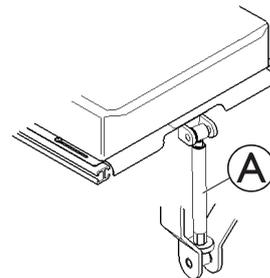
Die Abbildung zeigt die Position der Spindel **A** zur manuellen Verstellung des Sitzwinkels.
