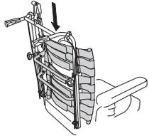
Setzen Sie die Rückenlehne in die Einsätze auf den Rohren wieder ein. Ziehen Sie die Schrauben fest.
