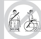
Der Crashtest-Dummy wurde mit einem Beckengurt und einem Sicherheitsgurt für den Oberkörper angeschnallt. Um die Gefahr von Kopfverletzungen oder Verletzungen des Oberkörpers zu minimieren, sollten beide Arten von Sicherheitsgurten verwendet werden.
