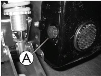
1. An der linken und rechten Seite des hinteren Gehäuses die beiden Handschrauben (A) lösen und entfernen.
