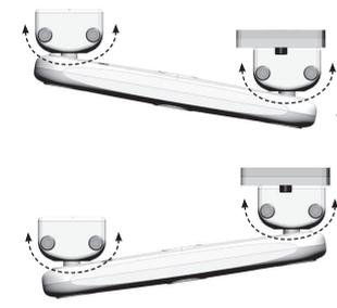
1. Lösen Sie die Schrauben **A** in jeder Kugelklemmeinheit.
