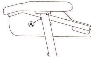
1. Lösen Sie die Schraube **A**.
