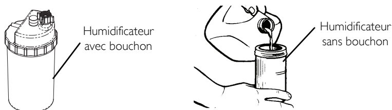
FIGURE 6.3 Remplissage de l'humidificateur
