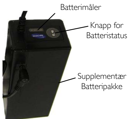
FIGUR 6.4 Lading av kun det Supplementære Batteriet
