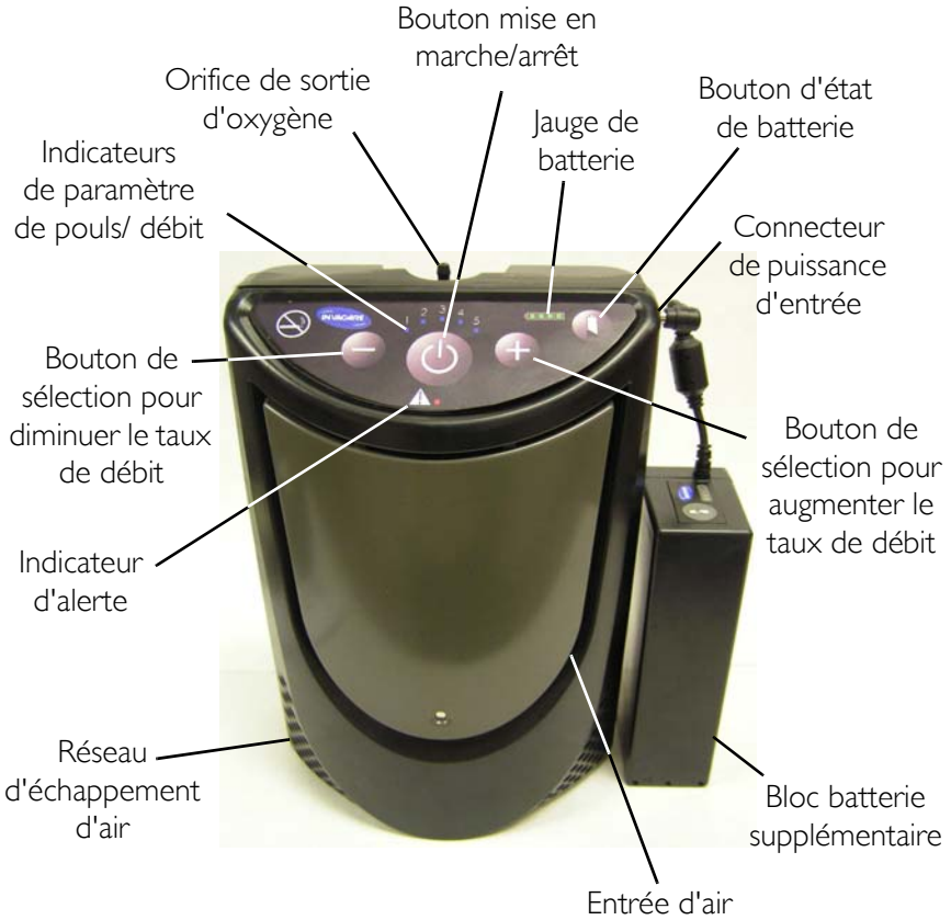
FIGURE 5.1 Caractéristiques techniques du XPO 2
