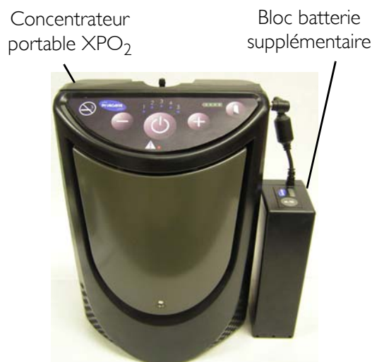
FIGURE 1 Connexion de la batterie supplémentaire au XPO 2
