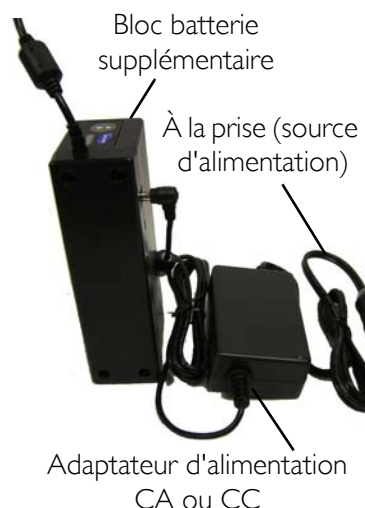
FIGURE 2 Chargement de la batterie supplémentaire
