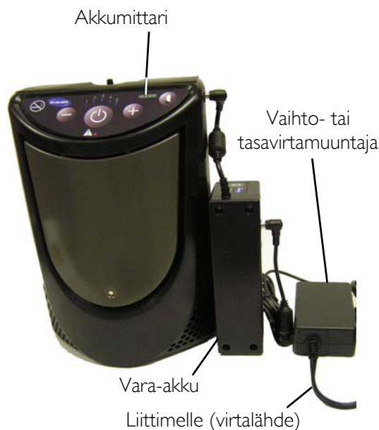
KUVA 3 Kiinteän ja vara-akun lataaminen samanaikaisesti
