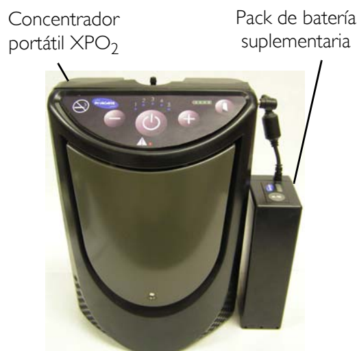
FIGURA 1 Conexión de la batería suplementaria al XPO 2
