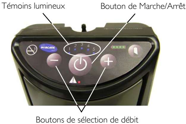
FIGURE 6.9 Réglage du paramètre de débit d'impulsion
