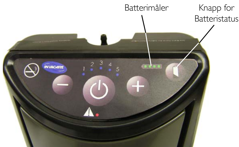
FIGUR 6.2 Kontroll av Ladenivået av det Interne Batteriet
