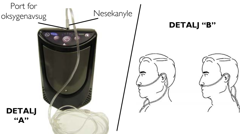
FIGUR 6.8 Tilkopling/Posisjonering av Nesekanyle
