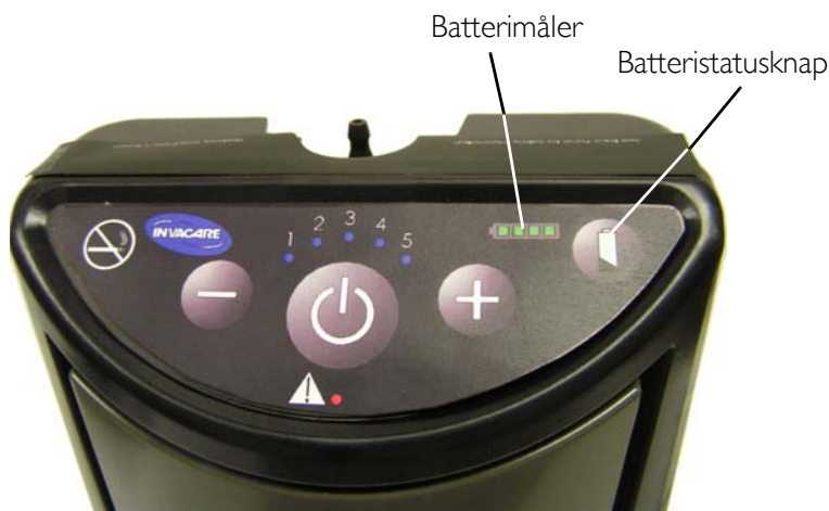
FIGUR 6.2 Kontrollere det interne batteris ladningsniveau
