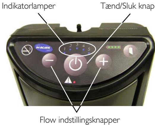
FIGUR 6.9 Justering af puls flow indstilling
