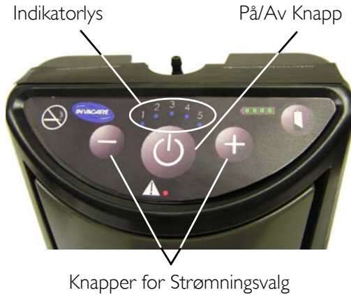
FIGUR 6.9 Justering av strømningsinnstillingen for puls
