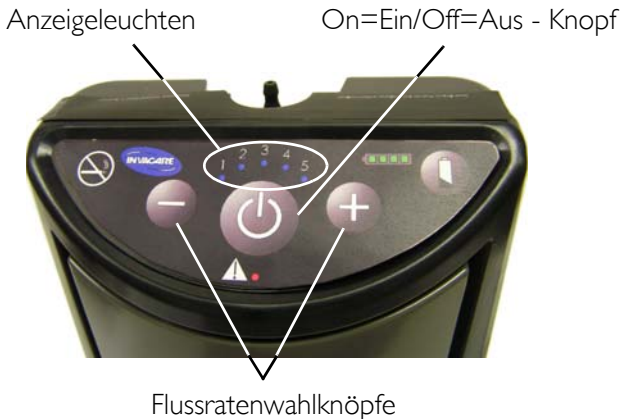
ABB 6.9 Einstellung der Impulsdurchflussrate
