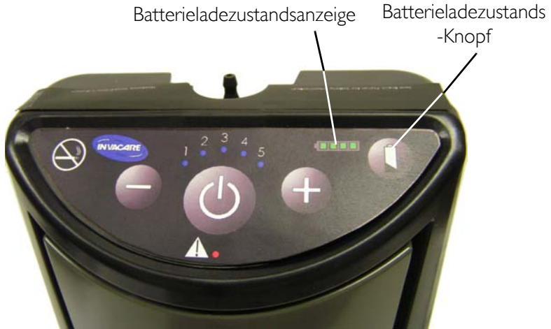
ABB 6.2 Überprüfen des Ladezustands der internen Batterie
