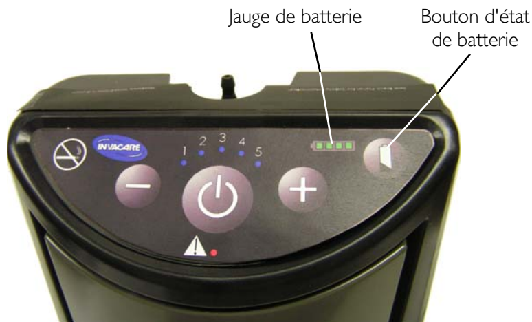
FIGURE 6.2 Vérification du niveau de charge de la batterie interne
