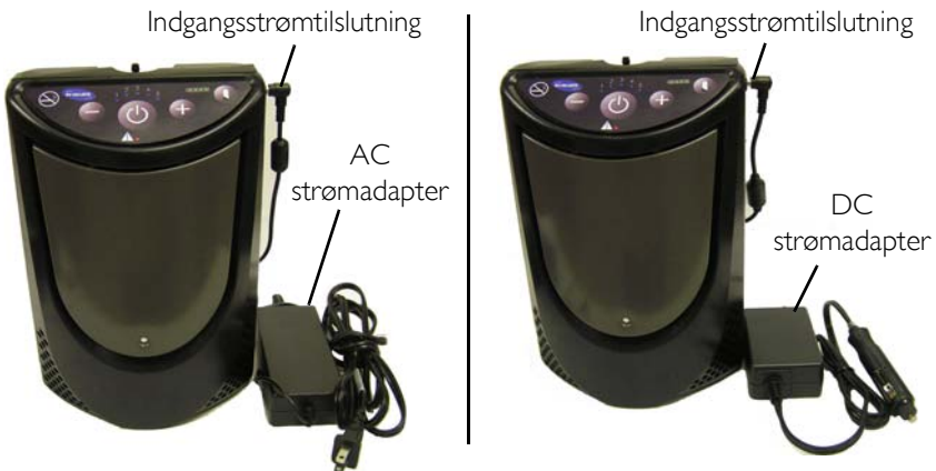
FIGUR 6.3 Opladning af det interne batteri
