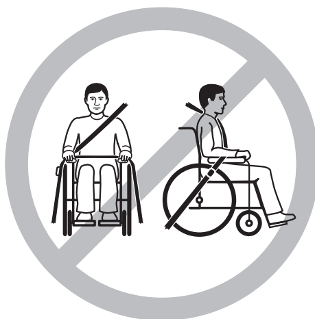
Colocación incorrecta del cinturón
