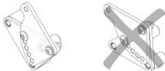
Les plaques à trous pivotantes arrière ont cinq positions. Celles-ci sont repérées sur l'illustration de droite par les lettres A à E.
