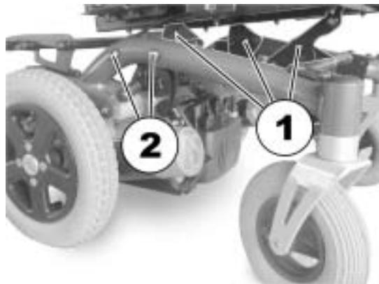
L'image à droite montre les plaques indexées de devant. La manière de procéder est similaire pour les plaques indexées de derrière. Pour le réglage des plaques indexées avant, une clé à fourche de 13 mm est nécessaire en plus de la clé mâle coudée pour vis à six pans creux de 5 mm.
