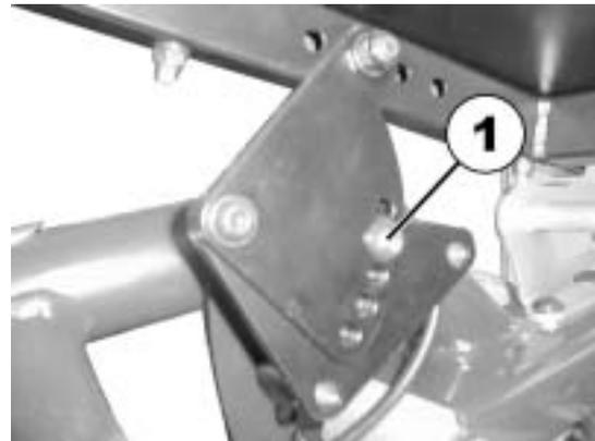
Pour le Dragon à réglage manuel de la hauteur et de l'angle d'assise, les plaques de retenue arrière ont deux positions possibles, en haut et en bas.
