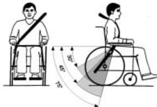
La ceinture de sécurité sous-abdominale doit pouvoir être appliquée dans le domaine situé entre bassin et cuisse de l'utilisateur sans être gênée ni trop lâche. L'angle optimal de la ceinture sous-abdominale par rapport à l'horizontale se situe entre  $45^\circ$  et  $75^\circ$ . La plage maximale est entre  $30^\circ$  et  $75^\circ$ . Ne dépasser en aucun cas un angle de  $30^\circ$  !
