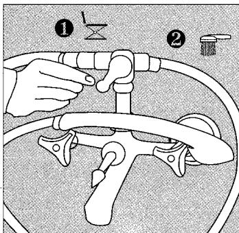
Nach dem Baden drückt man auf Position ① des Wippschalters, bis der Lifter seine Ausgangshöhe erreicht hat. Badewasser ablassen, den Lifter kurz abbrausen und die Bezüge waschen.
