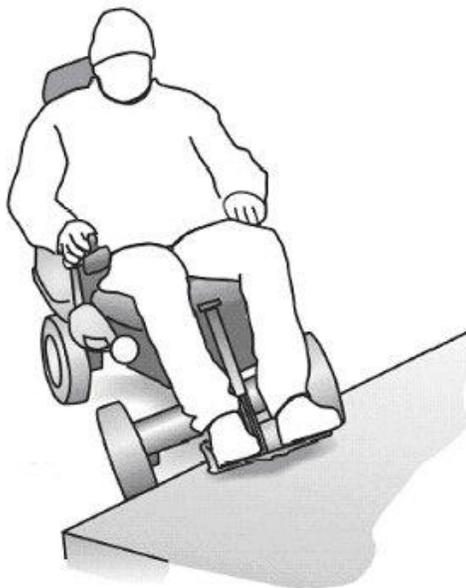
Le centre de gravité doit être ensuite avancé pour alléger l'arrière du fauteuil avant de monter totalement le trottoir (3). Le centre de gravité est ensuite bon à recentrer dans la position de conduite sur surface plane. Lors de passage de gros obstacle cette méthode peut également être utilisée. (4).
