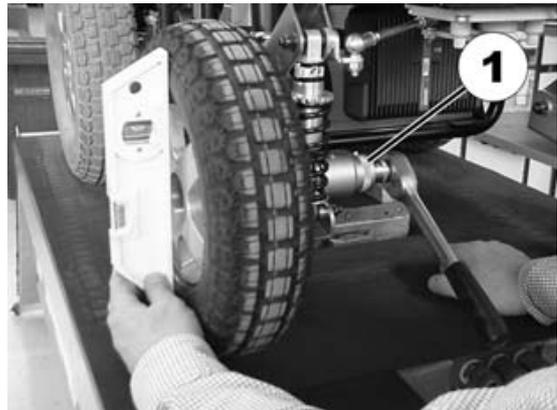
Bei der Verstellung des Radsturzes wird die Spur ebenfalls verstellt. Deshalb muss darauf geachtet werden, den Radsturz so einzustellen, dass der Abstand zwischen der Drehpunkt-Schraube (1) des Längslenkers und dem Reifen maximiert wird.
