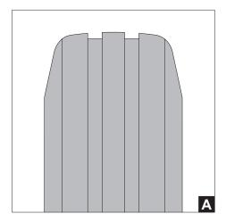
Votre viamobil est un appareil avec peu d'entretien À l'exception des pneus, aucune pièces de la propulsion n'est soumise à une usure significative. Pour garantir la transmission sûre de la force motrice et de freinage, les pneus ne doivent pas être en-dessous de la limite d'usure.
