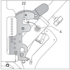
• Si l'axe inférieur [3] se trouve dans le logement inférieur [23], vous devez basculer le viamobil comme représenté sur le dessin vers l'avant afin de pouvoir enfoncer l'axe supérieur [4] dans le logement supérieur [22] du support.
