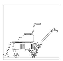
Poussez votre viamobil depuis derrière sous le fauteuil roulant, l'axe inférieur [3] devant être d'abord enfoncé dans le logement inférieur [23] du support.
