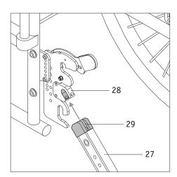
• Glissez le sabot de logement [29] sur l'anti-bascule [27] dans l'ouverture de la fourche [28].
