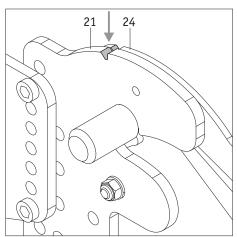
Votre viamobil ne doit être mis en marche que si les axes se trouvent correctement dans leurs logements et s'ils sont sécurisés des deux côtés du fauteuil roulant par le verrouillage.
