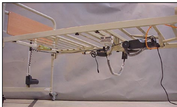
4. Mettez les câbles du moteur du pied de lit sur le crochet à l'extrémité du lit. Le relève buste doit être en position horizontale.
