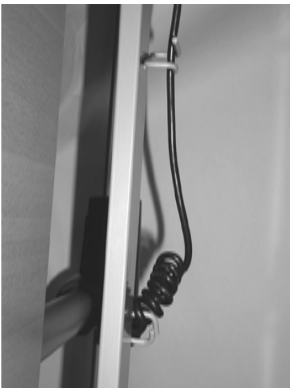
Bedrading van de hoofdsteun motor.
