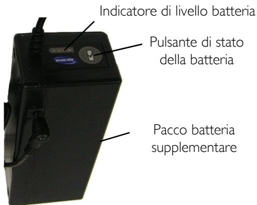
FIGURA 6.4 Carica della sola batteria supplementare
