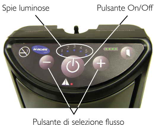
FIGURA 6.9 Regolazione dell'impostazione del flusso a impulsi
