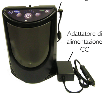
FIGURA 6.3 Carica della batteria interna
