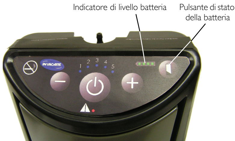
FIGURA 6.2 Controllo del livello di carica della batteria interna
