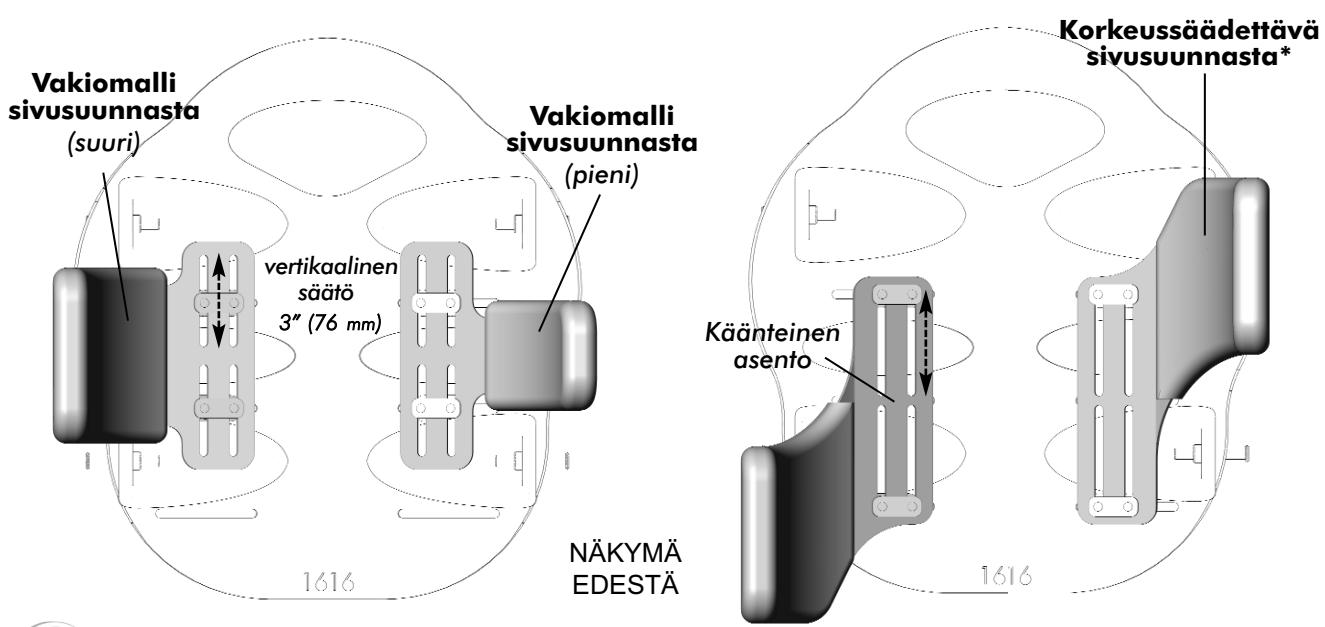
**\*Huomaa:** korkeussäädettävät sivutuet voidaan asentaa myös käänteiseen asentoon (kuva näkyvällä tavalla) lisätuen saamiseksi
