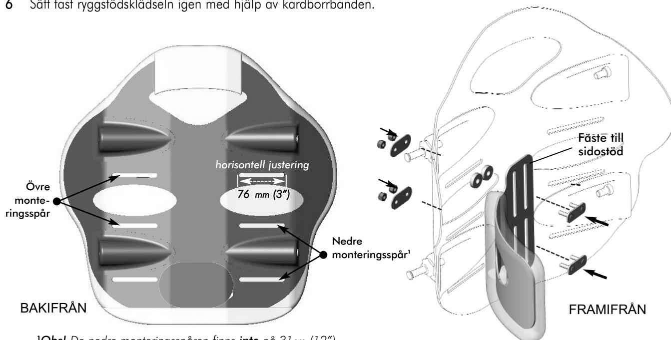
\*Obs! De nedre monteringsspåren finns **inte** på 31cm (12") höga MaTRx-PB elite-ryggstöd
