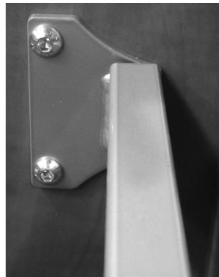
Para as extremidades das camas Sabrine e Camila, insira os suportes das extremidades da cama no tubo lateral da plataforma do estrado. Aperte bem os parafusos com uma chave Allen de 5 mm.
