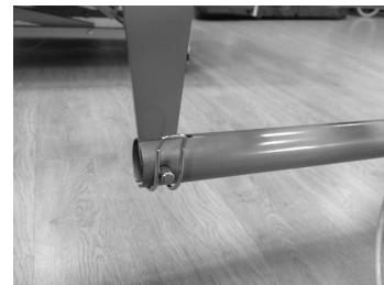
Una el tubo o la manivela del respaldo con el soporte; para ello, introduzca un pasador en el orificio superior del soporte.
