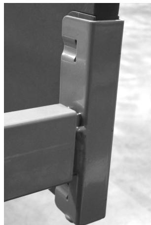
Per i pannelli Vibeke, inserire le staffe separate dei pannelli nel tubo laterale della rete e serrare a fondo le viti servendosi di una chiave a brugola da 5 mm. Abbassare il pannello nel raccordo con staffa a U e premere con forza per assicurarsi che il pannello sia completamente inserito nella parte inferiore del raccordo con staffa a U.
