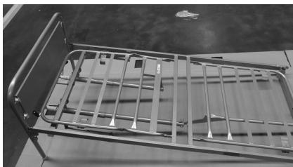
Fissare la rete ai pannelli e premere per assicurarsi che sia saldamente in posizione. Ripetere questa operazione su ogni pannello.
