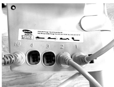
Conecte los cables del motor de la sección en la caja de control.
