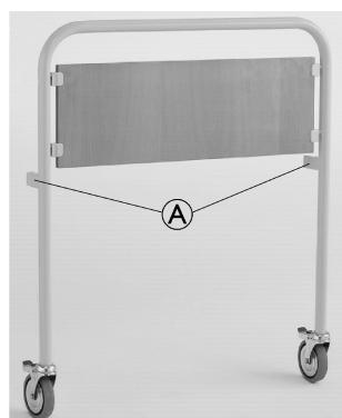
Inserire le staffe integrate **A** del pannello nel tubo laterale della rete e serrare a fondo le viti servendosi di una chiave a brugola da 5 mm. Ripetere questa operazione su ogni pannello.
