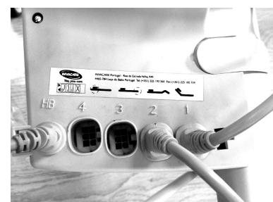
Ligue os cabos do motor da secção à caixa de controlo.
