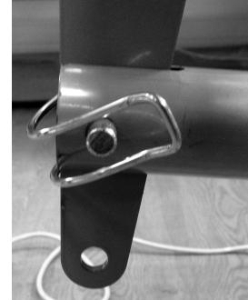
Fixez le tube de la section jambes au support de la section jambes au moyen d'une goupille dans le trou supérieur du support.
