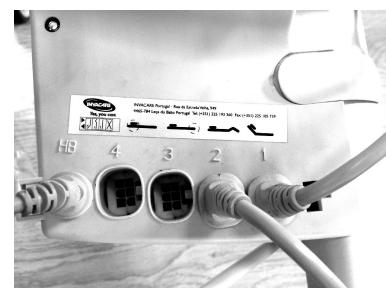
Collegare i cavi del motore della sezione alla centralina.
