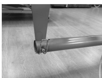
Fixe a manivela/tubo do encosto ao suporte do encosto, inserindo um pino de tubo no orifício do suporte.
