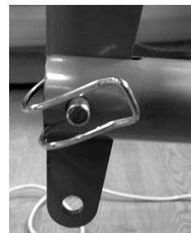
Una el tubo de la sección de las piernas con el soporte de dicha sección; para ello, introduzca un pasador en el orificio superior del soporte.
