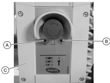
1. Insérez la pointe d'un stylo dans le trou en regard de la flèche d'urgence orientée vers le haut (A) ou vers le bas (B) sur l'unité centrale (C).
