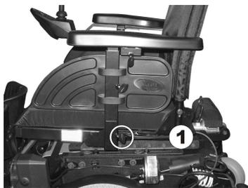
1. Lösen Sie die Flügelschraube (1).
