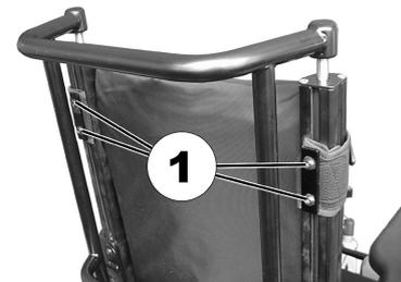
1. Die Schrauben (1) lösen.
