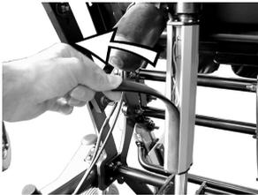
Legen Sie die Gummiabdeckung am oberen Ende des Steuerungskastens vorsichtig frei und nehmen Sie sie ab.
