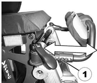
Die Löcher in den inneren und äußeren Rohren haben unterschiedliche Abstände. Die vielen möglichen Kombinationen von Löchern bieten die Möglichkeit der Feinjustierung der Halteschelle.
