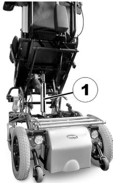
Der Steuerungskasten (1) für die Ausfahrbegrenzung der Hebevorrichtung befindet sich unter dem Sitz.
