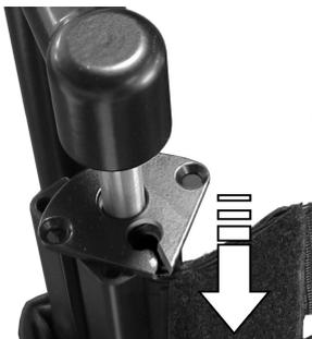
Rückenlehnschlinge und, falls erforderlich, Fixierungsstange wieder in den Rückenlehnenrahmen schieben.
