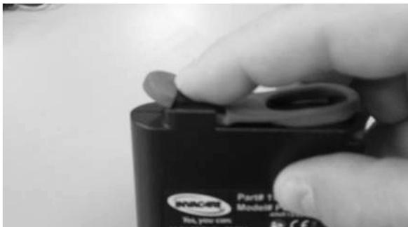
6. Continúe deslizando la anilla de tiro nueva hacia el montaje hasta que quede completamente acoplada.
