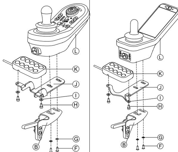
Monte el mando **L** en el adaptador del mando **B** y la hoja de soporte **J** con los tornillos **F** y las arandelas **G**.
