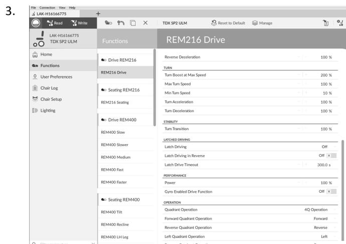
Ajuste el parámetro **Latched Driving in Reverse** (Conducción acoplada hacia atrás) en **On** (Activada), para permitir la conducción acoplada al dar marcha atrás.
