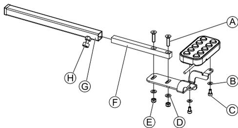
1. Fije el interruptor de 10 ajustes al bastidor mediante los tornillos © y las arandelas .
