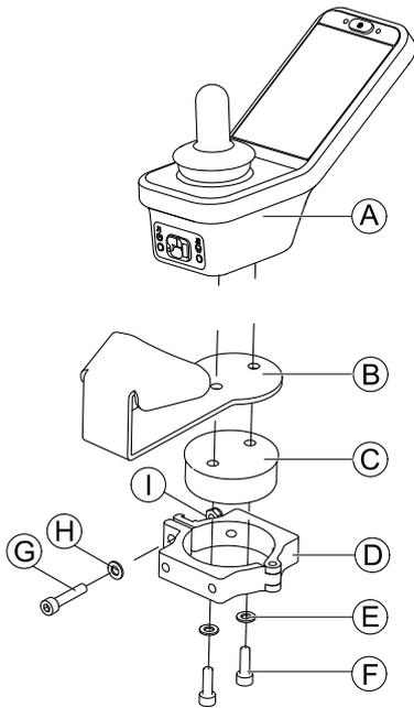
Fig. 3-36 Ejemplo de ajuste de DLX-REM400. DLX-REM110, DLX-REM211 y DLX-REM216 se ajustan de la misma manera.
