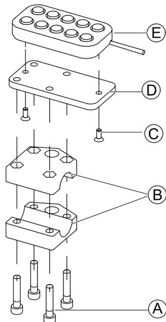
El interruptor de 10 ajustes se instala en la parte posterior de la silla de ruedas mediante un bastidor  en la empuñadura o la barra de empuje.
