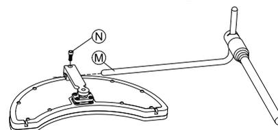
Deslice el soporte de enganche sobre el núcleo **M** y apriete con un tornillo **N**.
