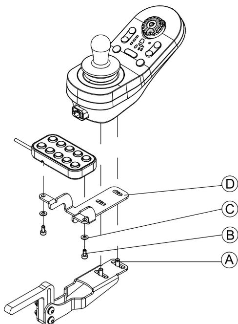
1. Fije el interruptor de 10 ajustes al bastidor  mediante los tornillos  y las arandelas .
