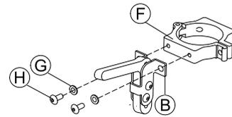
Fije la pinza F al adaptador de DLX-CR400 B con las arandelas G y los tornillos H.
