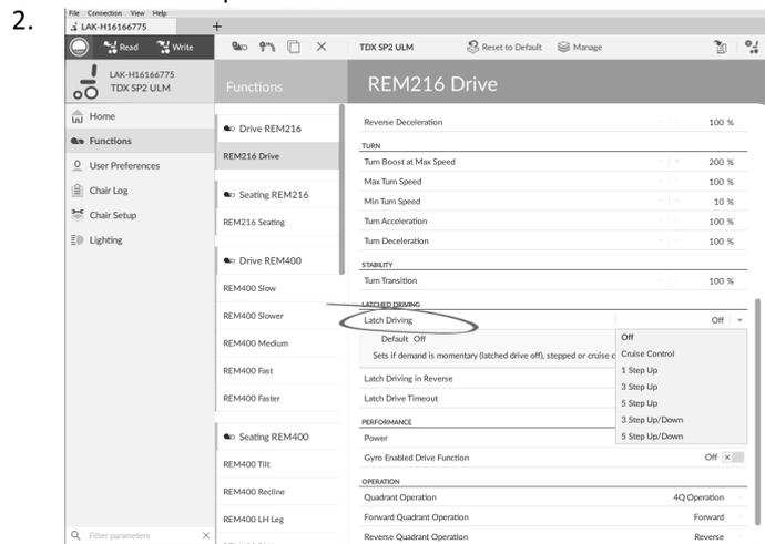
Ajuste el tipo de conducción acoplada con **Latched Driving** (Conducción acoplada). Para obtener más información sobre los tipos de conducción acoplada, consulte el manual del usuario del mando.
