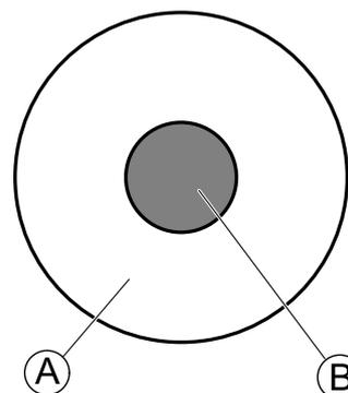
para los usuarios que tengan dificultad para mover el joystick, defina **Joystick Switch Threshold (Límite del conmutador del joystick)** a un valor bajo, por ejemplo el 40 % o menos,
