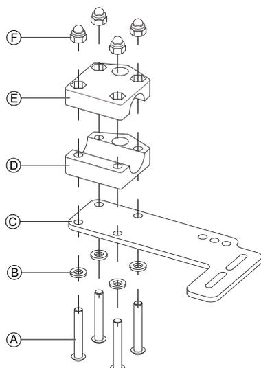
1. Introduzca los tornillos ① a través de las arandelas ②, la placa de montaje ③ y la parte inferior del bastidor ④.
