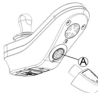
LiNX Access Key se conecta directamente al puerto XLR del módulo del mando **A**. En la imagen se muestra REM2xx, que funciona para REM400 y REM500 del mismo modo.
