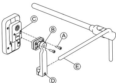
1. Monte el mando C en el bastidor B con tornillos A.
