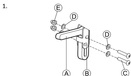
Monte el soporte del joystick **A** en el adaptador del mando **B** con los tornillos **C**, las arandelas **D** y las tuercas **E**.
