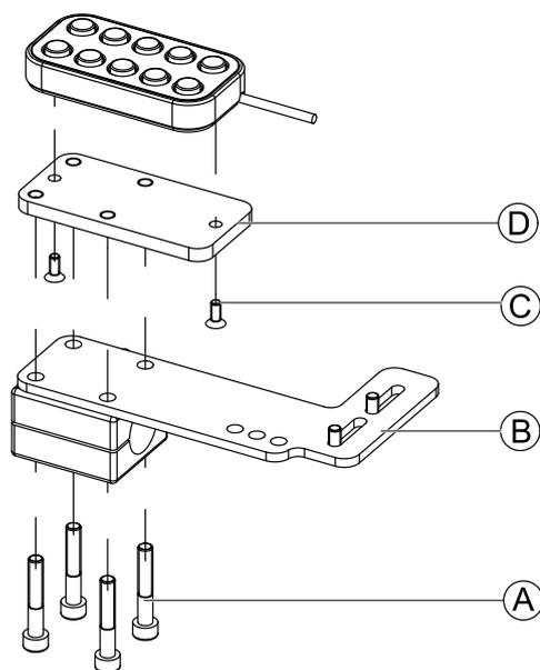
1. Fije el interruptor de 10 ajustes a la placa de montaje  mediante los tornillos .
