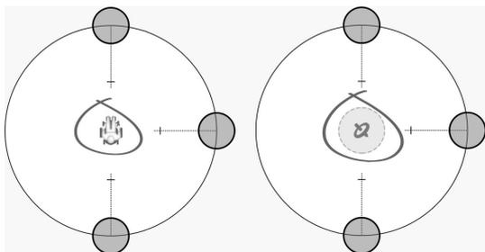
Si se activa un módulo de giroscopio, el icono del centro del gráfico cambia de una persona en una silla de ruedas a un giroscopio para indicar que el parámetro que se está cambiando es específico de un giroscopio.
