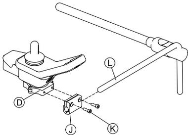
Fig. 3-37 Ejemplo de ajuste de DLX-REM400. DLX-REM110, DLX-REM211 y DLX-REM216 se ajustan de la misma manera.
