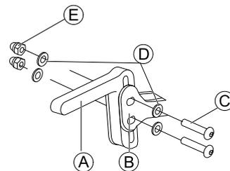
Monte el soporte del joystick Ⓐ en el adaptador del mando Ⓑ con los tornillos Ⓒ, las arandelas Ⓓ y las tuercas Ⓔ.
