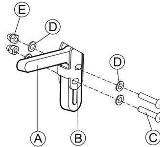
Monte el soporte del joystick A en el adaptador de DLX-CR400 B con los tornillos C, las arandelas D y las tuercas E.
