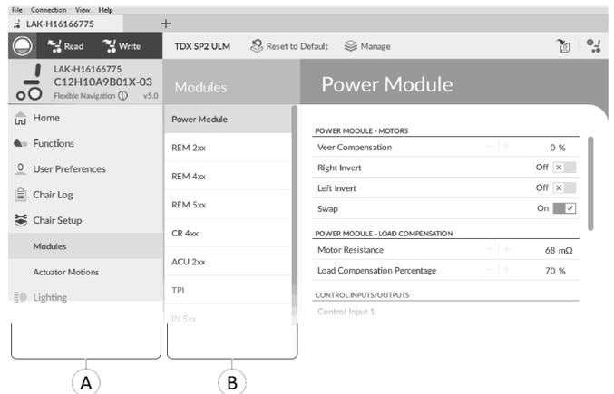
La barra de navegación secundaria (B) solo se muestra para ciertas selecciones de la barra de navegación principal (A) y permite desglosar las características, funciones y parámetros.
