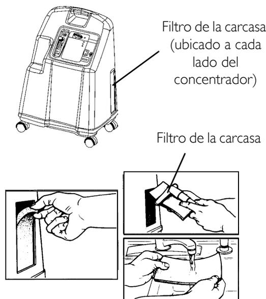
**FIGURA 6.1** Limpieza del filtro de la carcasa
