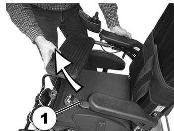
Suelte el sistema de sujeción de liberación rápida (1).
