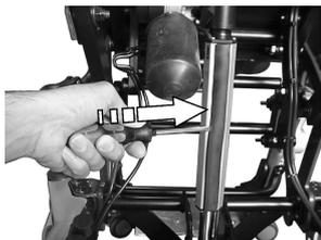
Vuelva a colocar la cubierta de goma y presiónela con cuidado en la ranura.
