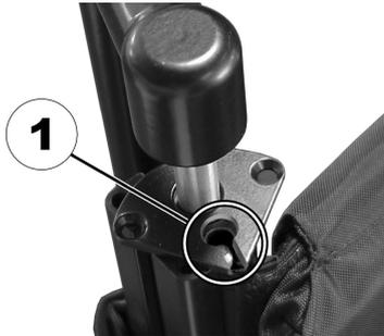
Gire cada cubierta de modo que el hueco (1) apunte hacia la parte delantera, colocada directamente sobre el extremo de la varilla de fijación de la eslinga del respaldo.
