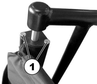
Vuelva a insertar los tornillos (1) en las cubiertas en los extremos de los tubos del chasis del respaldo y apriételes.
