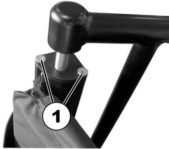
Afloje y retire los tornillos (1) que sujetan las cubiertas en los extremos de los tubos del chasis del respaldo.
