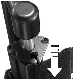
Empuje hacia abajo la eslinga del respaldo y, si fuera necesario, la varilla de fijación en el chasis del respaldo.
