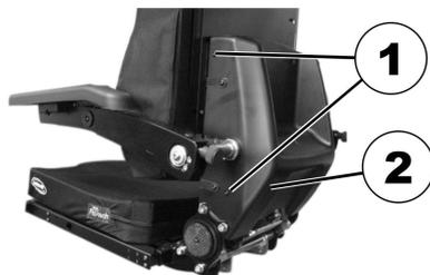
1. Suelte los tornillos a ambos lados de la tapa del respaldo (1).
