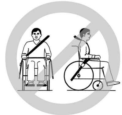
Los cinturones de seguridad no deben mantenerse alejados del cuerpo mediante partes del vehículo eléctrico, como los reposabrazos o las ruedas.
