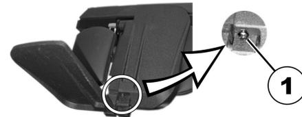
1. Pliegue hacia arriba las paletas del reposapiés para poder acceder a los tornillos de ajuste (1).
