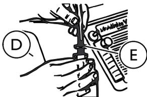
4. Tire hacia arriba del adaptador de la botella del humidificador (E) (al lado del filtro de entrada) para extraerlo.
