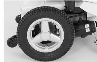
1. Gire el tornillo de acoplamiento hacia la izquierda. El motor se acoplará.
