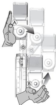
1. Empuje el medio del control remoto (A) para operar el mecanismo abatible.
