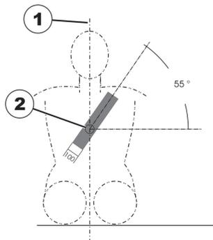
El cinturón de seguridad instalado en el vehículo de transporte debe usarse como se muestra en la ilustración anterior.
