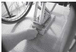
Empuje la herramienta de liberación de emergencia y la silla de ruedas eléctrica hacia delante, hasta que el pasador de bloqueo se haya forzado hacia abajo.
