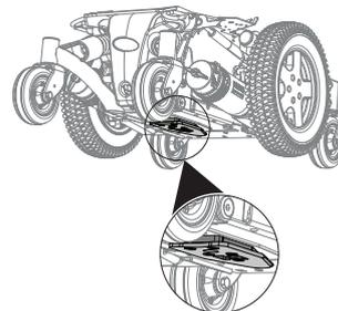
La placa de bloqueo (2) debajo de la silla de ruedas eléctrica ayuda a guiar la silla de ruedas eléctrica en la estación de acoplamiento Dahl.
