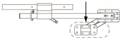
Para que el mando recupere la posición extendida normal, empuje hacia afuera en la superficie interna del mando, luego hacia adelante y adentro hasta que el eslabón de cuatro patas mueva su rango completo y haga clic en su posición completamente extendida.
