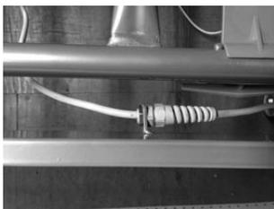
Guíe el cable de alimentación por el sujetacables que está situado en el chasis de la cama.
