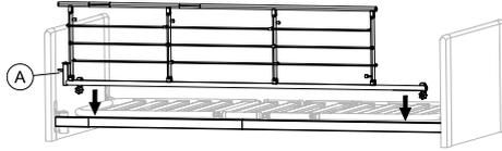
Coloque la barandilla sobre el chasis superior con el sistema de liberación **A** en el extremo del cabecero de la cama.
