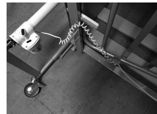
Coloque el cable del motor de subida/bajada de los pies en el gancho del extremo de la cama.
