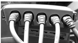
Instale la leva de bloqueo sobre los enchufes de la caja de control.
