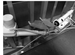
Guíe el cable del motor de subida/bajada desde el piecero de la cama y el cable del motor de la sección del muslo y la pierna a través del pasador del motor de la sección del muslo y la pierna. Asegúrese de que el pasador esté correctamente bloqueado.
