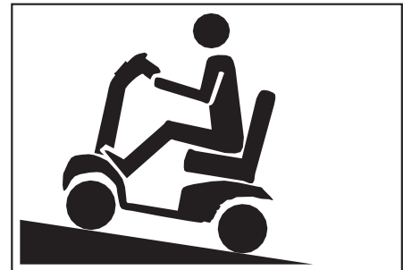
Verlagern Sie das Körpergewicht auf einer Steigungsstrecke nach vorne, um die Stabilität des Scooters zu erhöhen.
