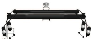
La largeur des tubes du dossier est de 25 mm. Les parties supérieures et inférieures des tubes sont réglables individuellement pour répondre à des besoins différents. Le mouvement vers l'extérieur encadrera l'utilisateur et offrira un support latéral.
