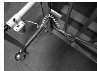
Placez le câble du moteur de montée/descente de l'extrémité pieds sur le crochet du panneau.
