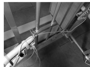
Placez le câble du moteur de montée/descente de l'extrémité tête sur les deux crochets du panneau et fixez-le sur la broche du moteur du relèvement de buste.
