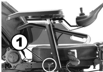
1. Détacher le câble du manipulateur du manipulateur. Voir 6.2.2 *Déconnexion du manipulateur*, page 78.
