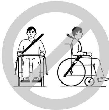
Les ceintures de sécurité ne doivent pas être écartées du torse de l'utilisateur par des parties du véhicule électrique telles que les accoudoirs ou les roues.
