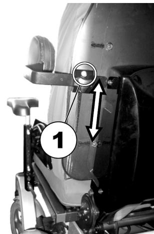
1. Desserrer les vis à six pans creux du réglage vertical (1).
