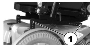
La photo montre la position des vis (1) servant au réglage manuel de l'angle d'assise.
