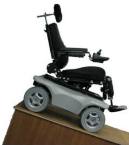
En descente, le réglage du centre de gravité est effectué en arrière
