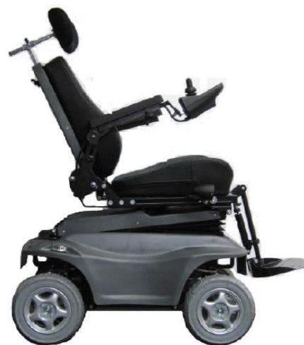
Sur un sol plat, le réglage du centre de gravité se trouve dans une position centrale et la partie avant de l'assise doit être légèrement relevée
