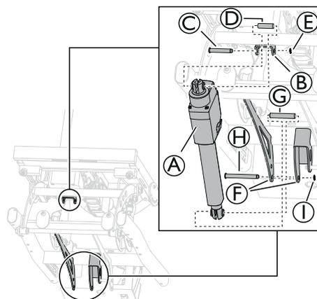
1. Inserire la parte superiore dell'attuatore di inclinazione del sedile (A) nell'attacco (B) sul telaio.
