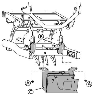
Montare il supporto della centralina (C) sulle piastre di fissaggio (B).
