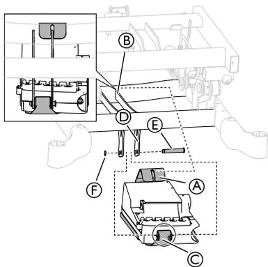
1. Montare la parte superiore del supporto della centralina (A) nell'attacco (B) sul telaio.
