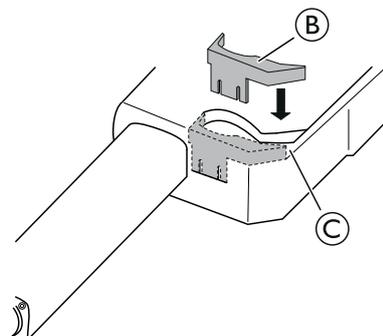
1. Inserire il cavo nel supporto (C) sull'attuatore di inclinazione del sedile.
