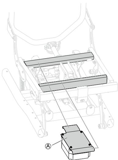
1. Montare l'attacco insieme alla batteria (A) sul telaio.
