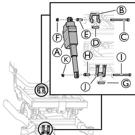
1. Inserire la parte superiore dell'attuatore di inclinazione del sedile (A) nell'attacco (B) sul telaio.
