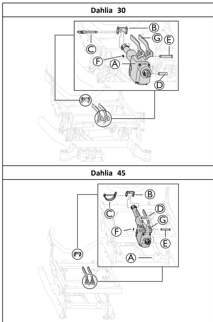
1. Inserire la parte superiore dell'attuatore dello schienale (A) nell'attacco (B) sul telaio.
