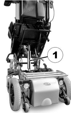
La centralina (1) per l'arresto di finecorsa del verticalizzatore si trova sotto il sedile.
