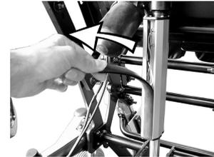
Sganciare e rimuovere con cautela la copertura in gomma sull'estremità superiore della centralina.
