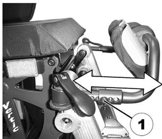
I fori nei tubi interni ed esterni sono distanziati in modo differente. Le molte possibili combinazioni dei fori consentono di regolare con precisione il fermo di fissaggio.
