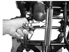
Riposizionare la copertura in gomma e inserirla con cura all'interno della scanalatura.
