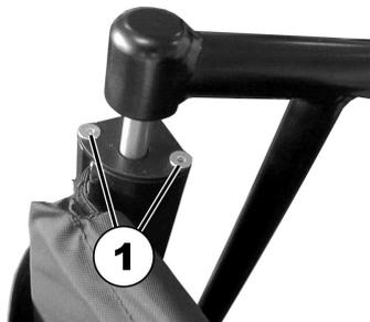
Allentare e rimuovere le viti (1) di fissaggio dei coperchi sulle estremità dei tubi del telaio dello schienale.
