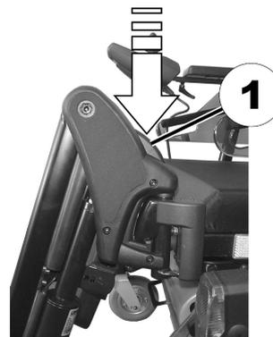
1. Premere il bottone di sblocco (1) e ruotare il portapedana verso l'esterno.
