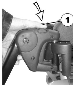
1. Premere il bottone di sblocco (1) e ruotare il portapedana verso l'esterno.
