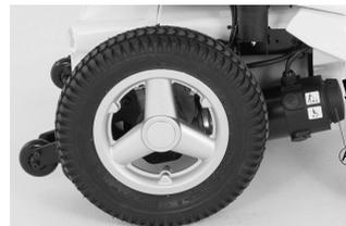
1. Ruotare la manopola di innesto in senso antiorario. Il motore viene inserito.
