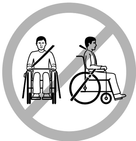
**i** L'immagine mostra un posizionamento errato della cintura pelvica a tre punti.
