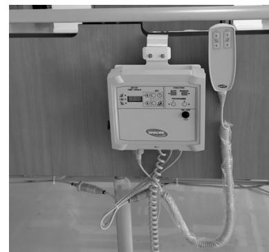
Samle motorkablene i en bunt og stram dem med en strips, juster sengen opp og ned for å forsikre deg om at bunten ikke sitter fast i noen av delene på sengen, men kan beveges fritt.
