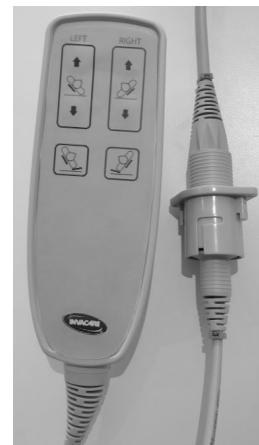
Koble håndkontrollen til kabelen ② og koble strømkabelen ① til strømnettet. Håndkontrollkabelen er markert ③ på kabelklemmen som tilsvarer ③ på kontrollbokskabelen.
