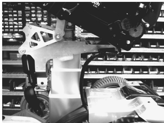
Fig. 6-75 Lyftstolpen helt upplyft
