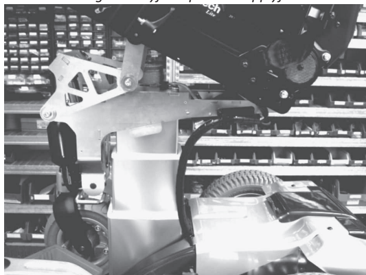
Fig. 11-7 Lyftstolpen helt upplyft
