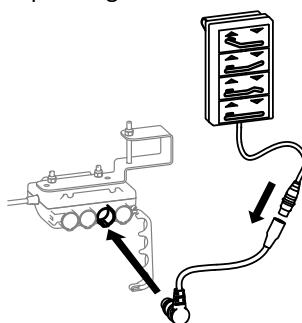
Med adapterkabelen kobler du den revmatiske håndkontrollen til den gule, markerte kontakten på spenningsboksen.
