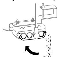
Asenna pikalukko uudelleen ja varmista, että se lukittuu paikalleen.
