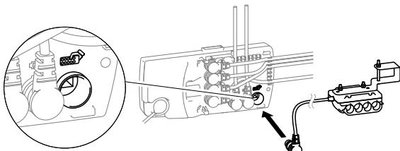
Slut kablet fra samlekassen til betjeningspanelet i stikket mærket med håndbetjeningssymbolet.
