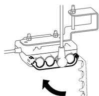
Reinstallare la camma di bloccaggio e assicurarsi che sia bloccata in posizione.
