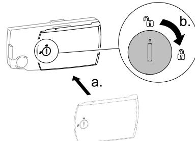
Riposizionare il coperchio sulla centralina e chiuderlo ruotando il meccanismo di bloccaggio di 90 gradi in senso orario.
