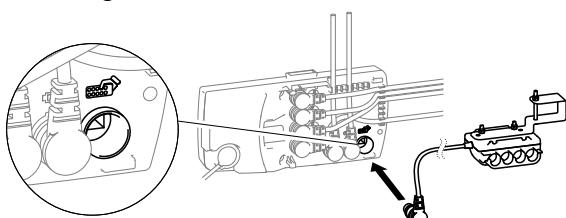
Sluit de kabel van de aansluitdoos aan op de bedieningseenheid, op de ingang met het symbool voor handbediening.
