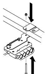
1. Placer kopplingsdosans monteringsfäste över sängbottenplattformens fyrkantiga rör.
