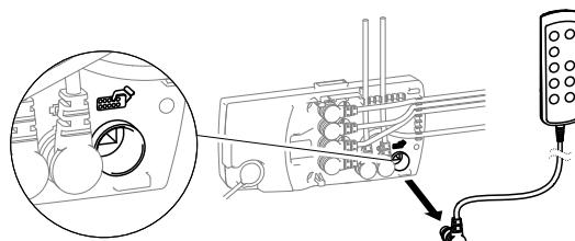
Frakobl kablet til den fastmonterede håndbetjening fra betjeningspanelet.
