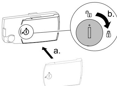
Sätt tillbaka locket på elektronikenheten och stäng det genom att vrida låset 90 grader medurs.
