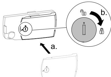
Sæt låget på betjeningspanelet igen, og luk det ved at dreje låsen 90 grader i retning med uret.
