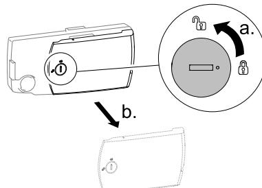
Drej låsen på betjeningspanelet 90 grader i retning mod uret for at åbne låget, og fjern det.
