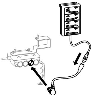
Anslut manöverdosan för reumatiker till det gulmarkerade uttaget på kopplingsdosan med hjälp av adapterkabel.
