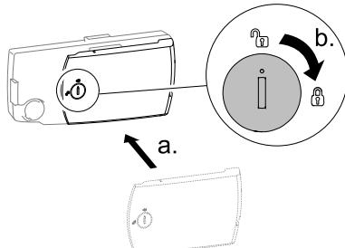
Plaats het deksel terug op de bedieningseenheid en sluit het deksel door de vergrendeling 90 graden naar rechts te draaien.
