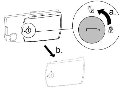
På elektronikenheten, vrid låset 90 grader moturs för att öppna locket och ta bort det.
