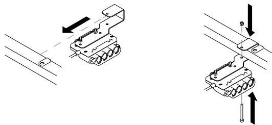
1. Posizionare la staffa di montaggio della scatola di derivazione sopra il tubo quadrato della piattaforma della rete.
