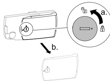
Sulla centralina girare il meccanismo di bloccaggio di 90 gradi in senso antiorario per aprire il coperchio e rimuoverlo.
