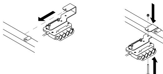
1. Plaats de montagebeugel van de aansluitdoos over de vierkante buis van het matrasbodemplatform.
