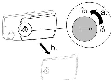
Draai de vergrendeling op de bedieningseenheid 90 graden naar links om het deksel te openen en te verwijderen.
