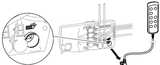
Haal de kabel van de verbonden handbediening los van de bedieningseenheid.
