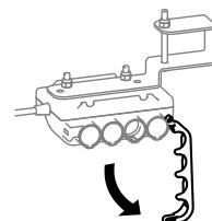
Rimuovere la camma di bloccaggio sulla scatola di derivazione.
