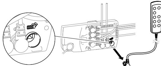
Koppla loss kabeln till den fast anslutna manöverdosan från elektronikenheten.
