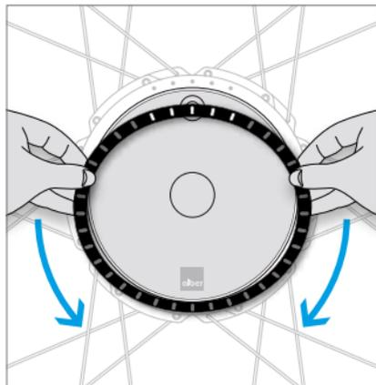
Am Ring entlangfahren, um die beiden restlichen Befestigungen zu lösen.
