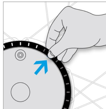
Ringrand umfassen und mit dem Daumennagel in die Kerbe drücken. Gleichzeitig nach außen ziehen.
