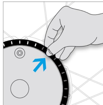
Saisissez le bord de l'anneau et enfoncez l'ongle du pouce dans l'encoche. Tirez simultanément vers l'extérieur.
