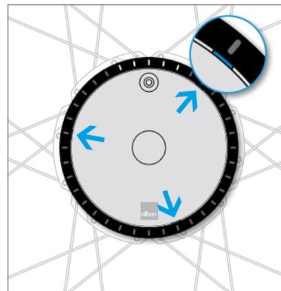
Einen der 3 Aussparungsschlitz am äußeren Rand der Abdeckung finden (zwischen Ring und Abdeckung).
