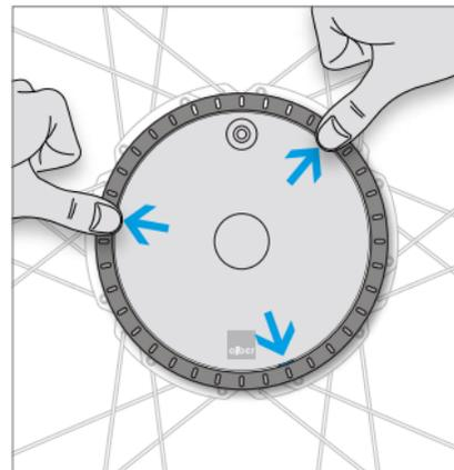
Stifte auf der Unterseite des Rings in die vorgesehenen Öffnungen einstecken und die 3 Verschlussstellen durch Drücken einrasten lassen.
