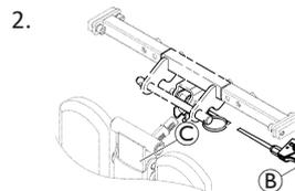
Mantenere saldamente il portapedana e tirare la leva (B).
