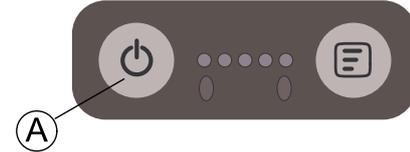
El botón de alimentación **A** se encuentra en el lado izquierdo del módulo del mando; incorpora un indicador de estado que cambia de color en función del estado del sistema:
