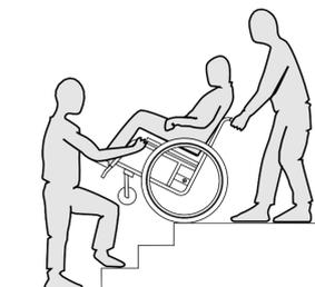
1. Puede subir y bajar escaleras yendo escalón por escalón, tal y como se describe más arriba. El primer auxiliar debe quedarse detrás de la silla de ruedas sosteniendo las empuñaduras. El segundo auxiliar debe sostener una parte sólida del bastidor delantero para estabilizar la silla de ruedas desde la parte delantera.
