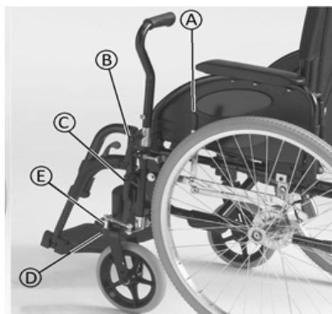
El usuario agarra la palanca de accionamiento que impulsa la silla de ruedas hacia delante o hacia atrás (palanca de marcha atrás (A), la posición central es el punto muerto) gracias a un movimiento hacia dentro y hacia fuera; la dirección se controla simplemente girando la palanca de accionamiento a la izquierda o a la derecha y el frenado, tirando de la palanca de accionamiento hacia atrás.
