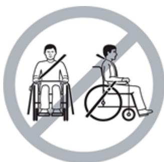
**i** La imagen muestra una colocación incorrecta de la fijación del cinturón de tres puntos.
