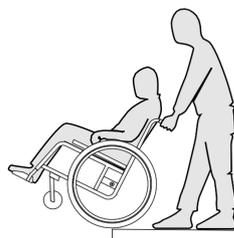
1. Mueva la silla de ruedas hasta el bordillo y sujete los aros de propulsión.
