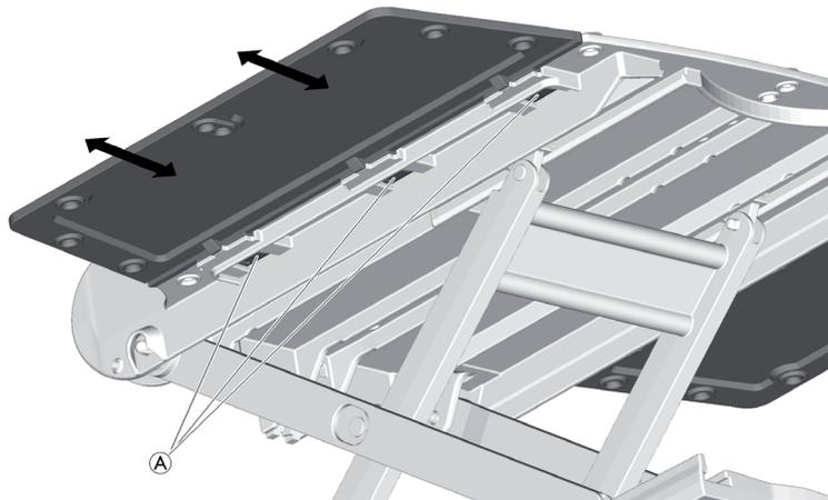
1. Clips **A** der Seitenklappe von einer Seite beginnend eindrücken und gleichzeitig die Seitenklappe langsam herausziehen.
