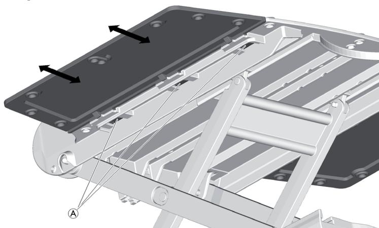
1. Clips ① der Seitenklappe von einer Seite beginnend eindrücken und gleichzeitig die Seitenklappe langsam herausziehen.
