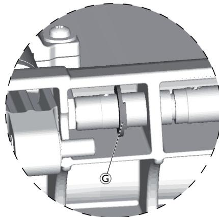
9. Alten Bolzen rechts © und alten Bolzen links © durch die mitgelieferten Bolzen ersetzen.
