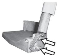
1. Afloje ambos tornillos de ajuste en el reposapiés.
