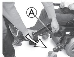
1. Mantenga el reposapiernas en la zona de la paleta del reposapiés, tire de la palanca de ajuste lateral **A** y baje el reposapiernas lentamente.
